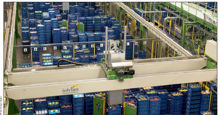
Le picking de produits, une spécialité d'Intrion : le produit est prélevé, qu'il arrive pêle-mêle ou non, puis déposé exactement à l'endroit et dans la position déterminée.
