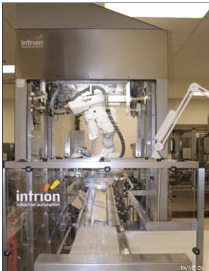
Intrion a développé et construit cette ligne de conditionnement robotisée pour le compte de l'entreprise pharmaceutique Schering-Plough Labo à Heist-op-den-Berg.
