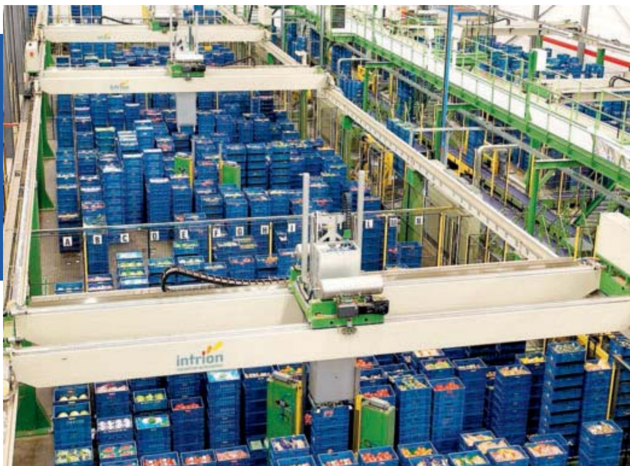
Colruyt behandelt 150 verschillende soorten groente, fruit en brood met de Orderpicker. De indrukwekkende robotinstallatie verwerkt maar liefst 2.500 bakken per uur.
